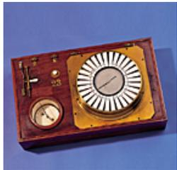
电子指针式电报机--电报机的先驱
